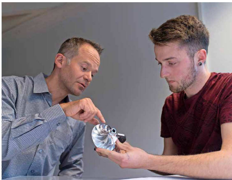
Le professeur Christian Nellen (à g.) et Simon Gillioz, collaborateur scientifique, inspectent une roue de turbocompresseur, destinée à augmenter la densité de l'air qui entre dans le moteur pour doper sa puissance. Alain Wicht
